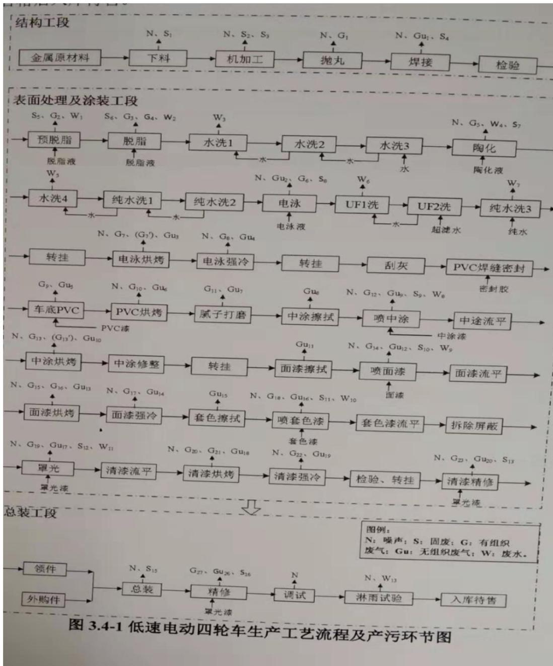
图 3.4-1 低速电动四轮车生产工艺流程及产污环节图
